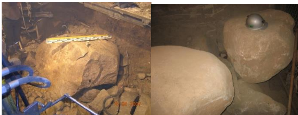
Рисунок 3 – На данном участке галечниковые грунты представлены обломками гранитов, гранодиоритами
